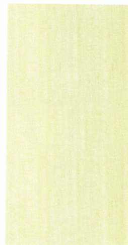
2c Sección tangencial longitudinal
