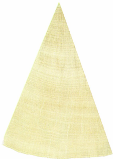
2a Sección transversal (albura y duramen)
